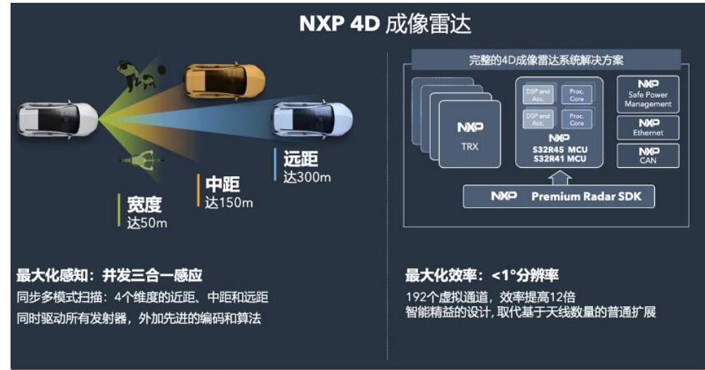
图 ADS 3.0使用4D毫米波雷达
