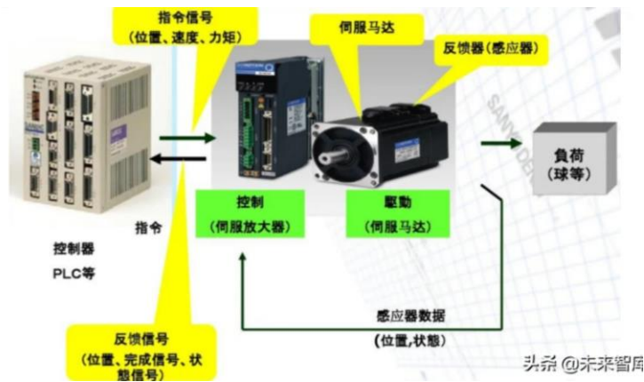
图 28：伺服系统工作示意图
